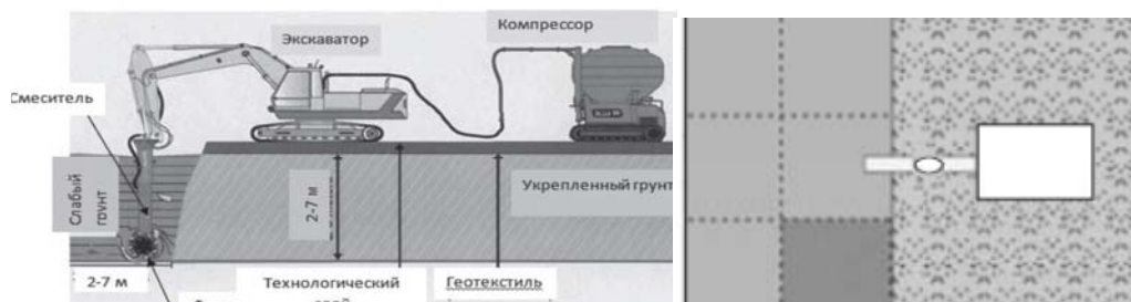
Рис. 2. Метод блочной стабилизации грунта
