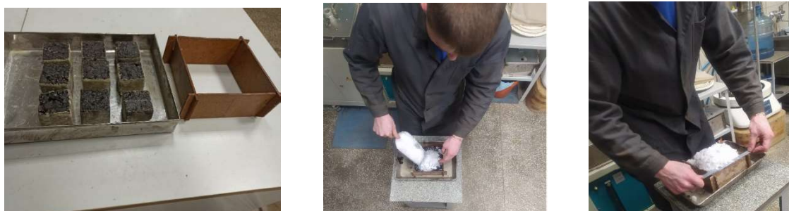
Рис. Контрольные образцы с ограничителями, засыпка и разравнивание слоя снега
