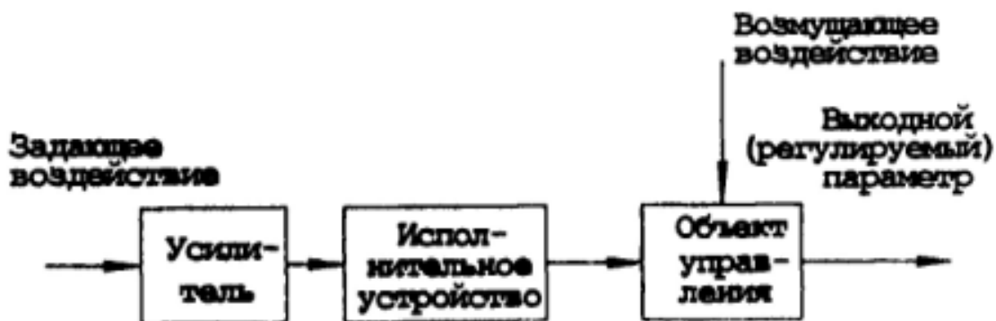
Рис. 1.1. Структурная схема разомкнутой САУ
