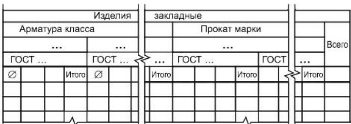
A.7 В подзаголовках граф ведомости расхода стали указывают класс арматуры или марки стали проката и соответствующие стандарты или технические условия. Ниже указывают: для арматурной стали - диаметр, для профильной - условное обозначение профиля.
