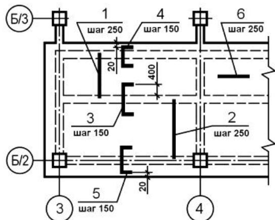
Примечание - Распределительную арматуру (поз.6) укладывать в пределах позиций 1 и 2 поверху, в пределах позиций 3-5 - понизу.
