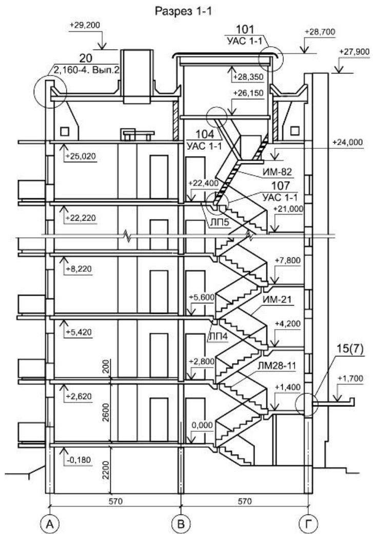
Рисунок Г.3 - Пример выполнения разреза жилого дома
