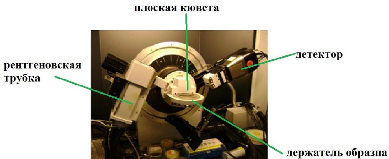
Рис.5. Гониометр порошкового автоматического дифрактометра Bruker D8-Advance с линейным счетчиком импульсов рентгеновских квантов VANTEC
