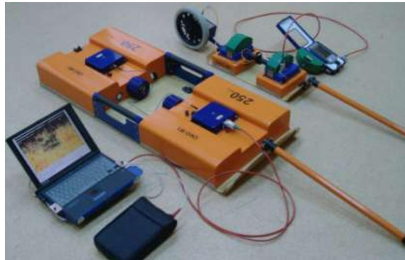
Рис. 1. Георадар ОКО, антенный блок АБ-400. Работа по обследованию ВПП
