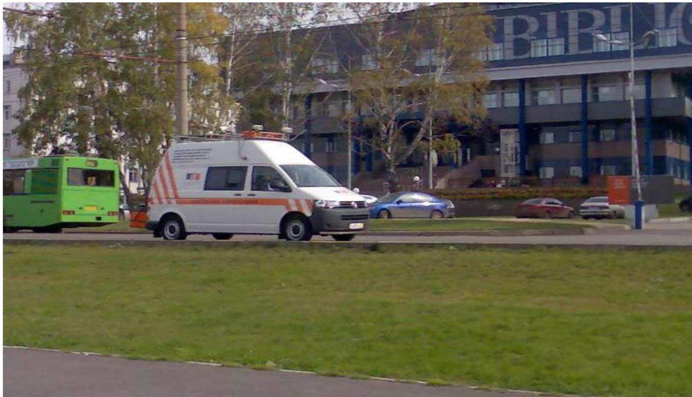
Оборудование передвижной лаборатории обеспечивает проведение видеосъемки, регистрации параметров проезжей части, земляного полотна, элементов обустройства и придорожной полосы дороги. Результаты камеральной обработки обеспечивает пополнение компьютерной базы дорожных данных и решение прикладных задач.
