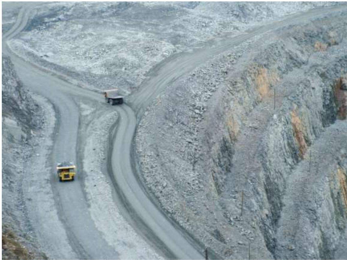
Проектирование дорог промышленных предприятий (карьерных, лесовозных, внутренних, служебных, патрульных). Проектирование и обоснование размещения площадок стоянки и обслуживания карьерной и лесовозной техники. Оптимизация и расчет дорожной одежды под сверхнормативную нагрузку.
