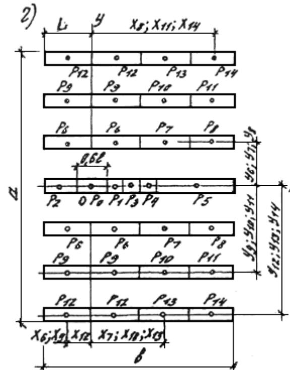
$a, b$  - нагрузки, равномерно распределенные по длине параллельных следов (от прокладок под тяжелые предметы, от штабелей цилиндрических валов и др.) при  $b \leq 4,4l$ ;  $a > b$ ;  $b, b'$ ,  $a$  - то же, при  $b > 4,4l$ ;  $a > b$
