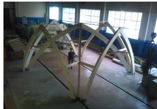
Отработка технологии изготовления, сборки и монтажа гнуто-клееных деревянных элементов на базе научно-учебной лаборатории испытания строительных материалов и конструкций Инженерно-строительного института СФУ
